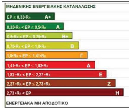
Σχήμα 1 – Πίνακας κριτηρίων ενεργειακής κατάταξης κτιρίου
