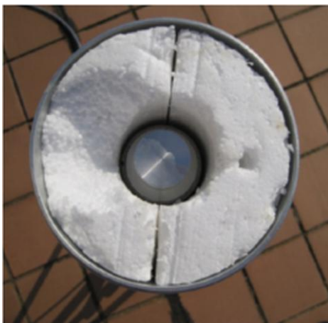
Εικόνα 2: Άποψη του ανιχνευτή \text{LaBr}_3(\text{Ce}) . Στο κέντρο φαίνεται ο κρύσταλλος \text{LaBr}_3(\text{Ce})
