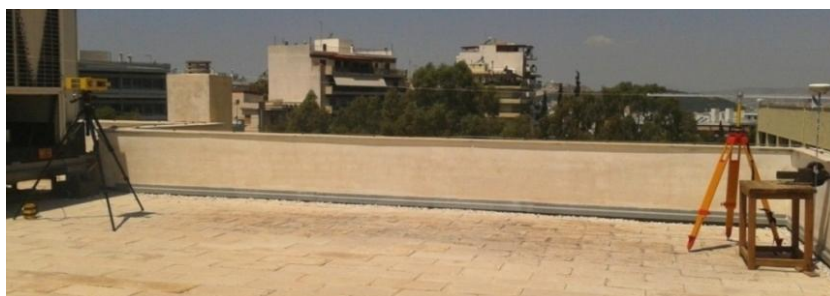
Σχήμα 2: Γεωμετρία παρατήρησης συστήματος radar μικροκυματικής συμβολομετρίας
