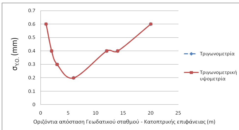
Σχήμα 8: Το σφάλμα στον προσδιορισμό του Υ.Ο. και στις δύο περιπτώσεις (τριγωνομετρική υψομετρία – τριγωνομετρία) ανάλογα με την οριζόντια απόσταση μεταξύ κατόπτρου και γεωδαιτικού σταθμού.
