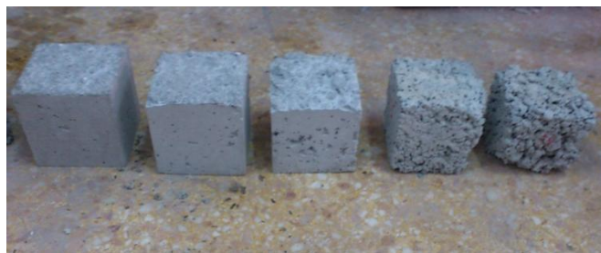
Σχήμα 1: Δοκίμια σκυροδέματος με διαφορετική πυκνότητα-πορώδες
