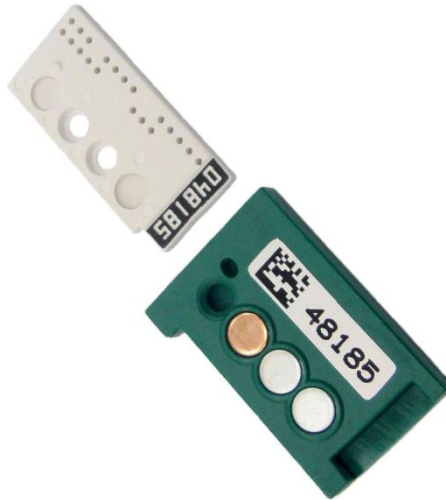
Εικόνα 1: Δοσίμετρο σώματος για τον υπολογισμό των μεγεθών Hp(10) και Hp(0.07)
