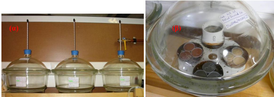
Φωτογραφία 1. α) Θάλαμοι υπέρκορων υδατικών διαλυμάτων αλάτων του εργαστηρίου της ΕΔΑΦΟΣ Α.Ε., και β) θάλαμος υπέρκορου διαλύματος KCl με δείγματα αναζυμωμένων υλικών (τριπλοί μικρού μεγέθους δειγματολήπτες εντός μεγαλύτερου δειγματολήπτη) και δοκίμιο αναζυμωμένου υλικού για την παρασκευή τελικά δοκιμίου θλίψης κατά γενέτειρα. Διακρίνονται τα θερμομέτρα παρακολούθησης της θερμοκρασίας στην ατμόσφαιρα των θαλάμων.
