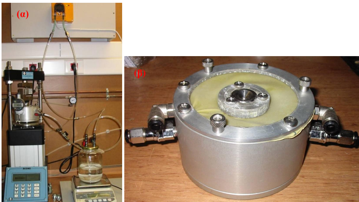
Φωτογραφία 2. α) Συμπιεσόμετρο με κυψέλη ελεγχόμενης μύζησης διά υπέρκορου υδατικού διαλύματος του εργαστηρίου της ΕΔΑΦΟΣ Α.Ε. (διακρίνεται το δοχείο διατήρησης του διαλύματος, ο ζυγός παρακολούθησης του συνολικού βάρους του, η περισταλτική αντλία εξασφάλισης της κυκλοφορίας του αέρα ελεγχόμενης μύζησης και η συνδεσμολογία κυψέλης-δοχείου), και β) η τροποποιημένη κυψέλη (Μπαρδάνης 2011).
