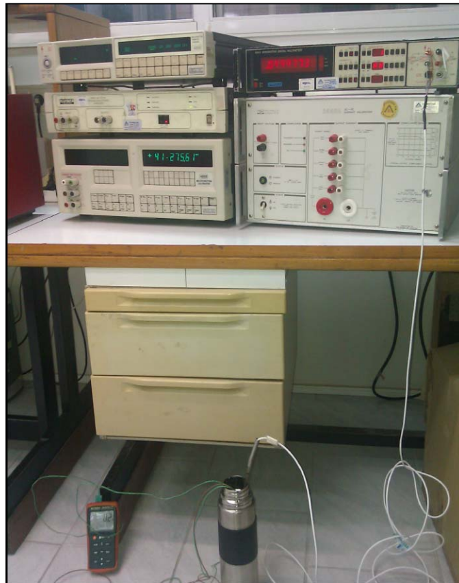
Σχήμα 7. Έλεγχος θερμοκρασίας ( 0^{\circ}\text{C} ) εντός της ψυχρής διάταξης με πρότυπη θερμοαντίσταση
