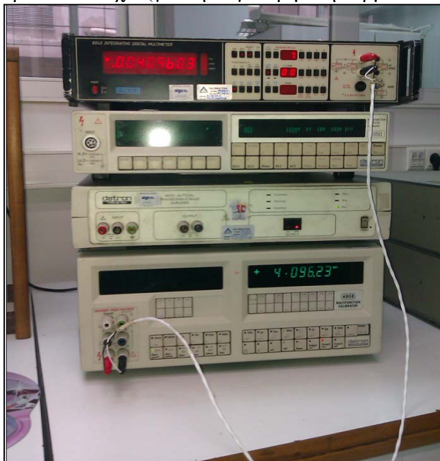
Σχήμα 4. Συμφωνία πρότυπης πηγής τάσης και πρότυπου πολυμέτρου στους 100 °C
