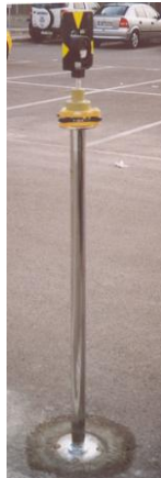
Εικόνα 2. Αποσπώμενο μεταλλικό βάθρο
