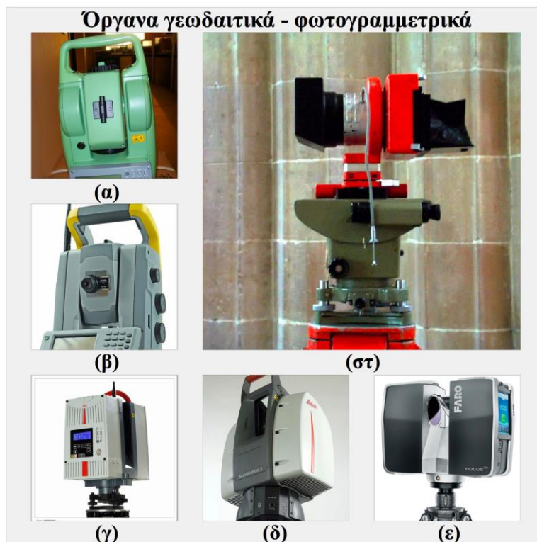
Σχήμα 3. Σύγχρονα αντιπροσωπευτικά γεωδαιτικά όργανα που χρησιμοποιούνται στις γεωδαιτικές μεθόδους: (α). Γεωδαιτικός σταθμός χωρίς απαίτηση πρίσματος (β). Ρομποτικός γεωδαιτικός σταθμός (γ), (δ), και (ε). Διάφοροι τύποι Laser scanner (στ). Επίγεια φωτογραμμετρική κάμερα.
