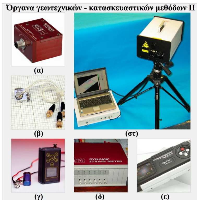
Σχήμα 2. Αντιπροσωπευτικά όργανα που χρησιμοποιούνται στις γεωτεχνικές και κατασκευαστικές μεθόδους II: (α). Ψηφιακό κλισίμετρο (β). Επιταχυνσιόμετρο τριών αξόνων (γ). Vibrometer (δ). Strainmeter (ε). Vibrometer με ψηφιακό αλφάδι (στ). Laser scanner και Laser Vibrometer.
