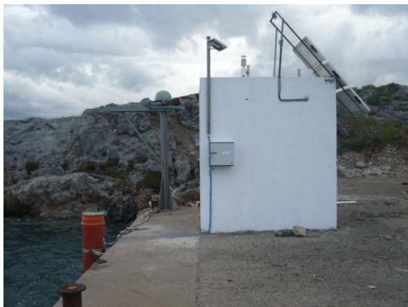
Εικόνα 3. Τα δύο συστήματα παλιρροιογράφων (ΟΤΤ & VEGA)
