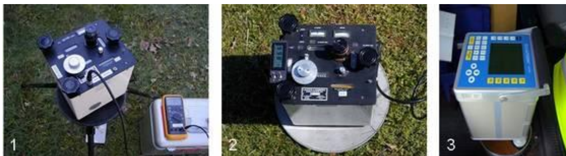
Εικόνα 1. (1) Βαρυτίμετρο LCR εφοδιασμένο με πλακέτα MVR και πολύμετρο, (2) Βαρυτίμετρο LCR, (3) Βαρυτίμετρο Scintrex CG-5
