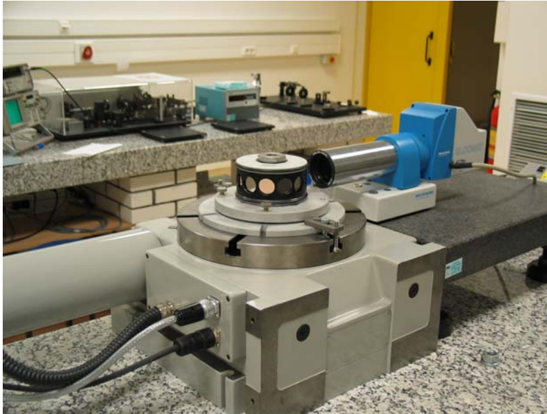
Σχήμα 1. Σύστημα διακρίβωσης προτύπων γωνιών.
