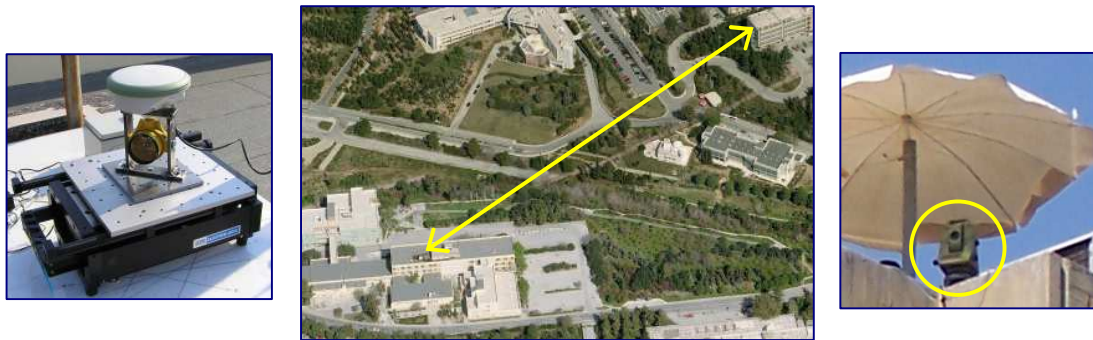
Σχήμα 5: Γεωμετρία παρατήρησης RTS και GPS σε συνθήκες εξαναγκασμένης ταλάντωσης .
