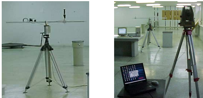
Σχήμα 3: Διάταξη περιστρεφόμενου βραχίονα ελέγχου RTS σε εξαναγκασμένη κυκλική κίνηση.
