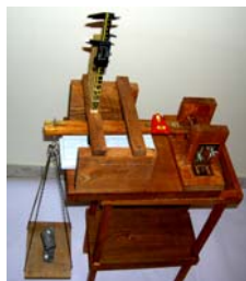
Εικόνα 1 : Φωτογραφία και σχηματική αναπαράσταση της πειραματικής διάταξης μελέτης της σκληρότητας των θερμομονωτικών υλικών
